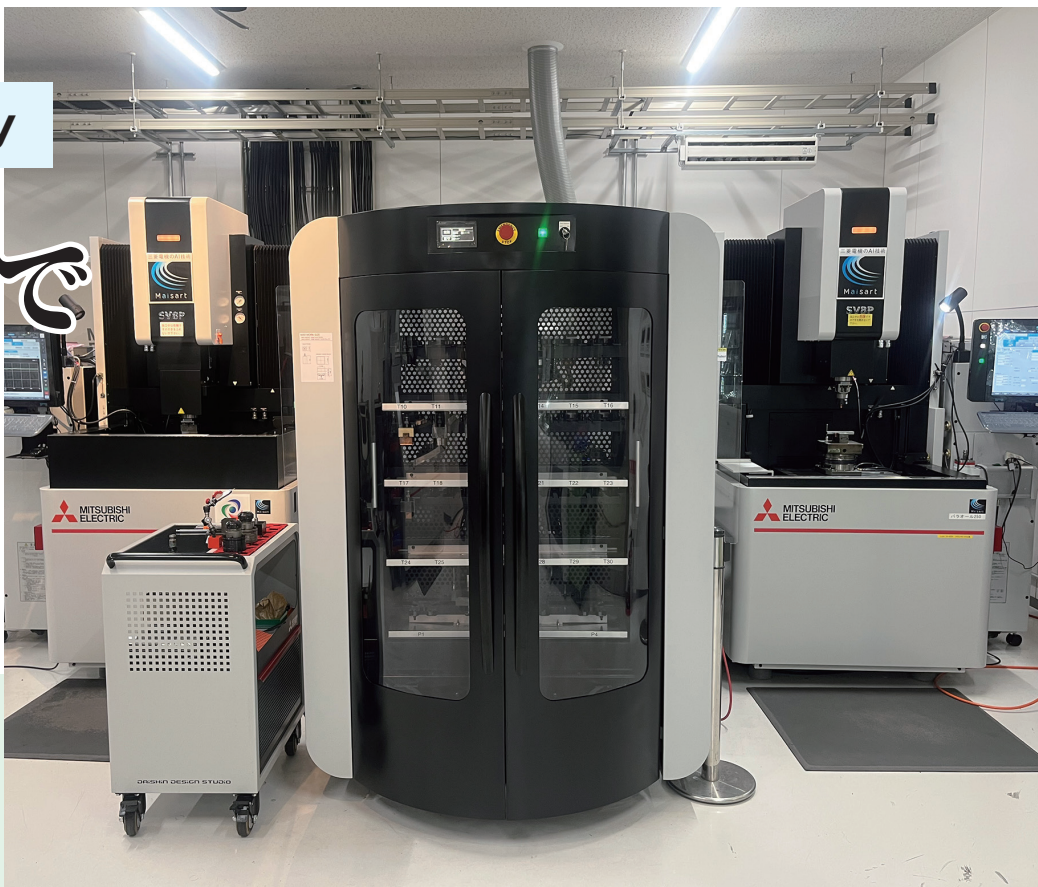
月728時間稼働を支える三菱電機の自動化システム「ED CHANGER」
