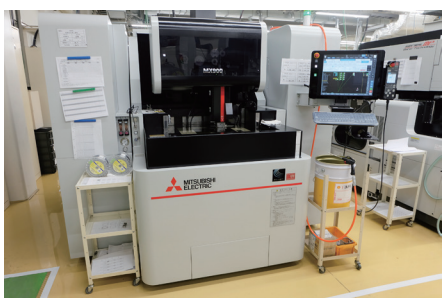
0.12mmピッチの狭ピッチコネクタを製作した三菱電機の油仕様のワイヤ放電加工機「MX900」
